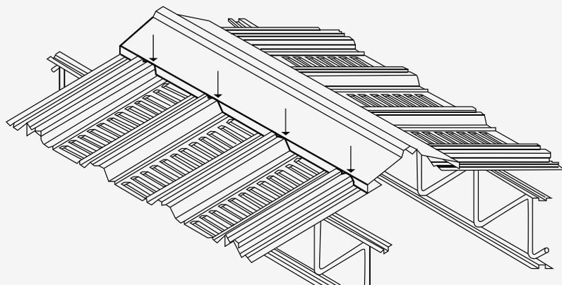
El **caballete para lámina CM-100/35** es una moldura para cubrir el parteaguas de un techo construido con láminas acanaladas del mismo tipo.
