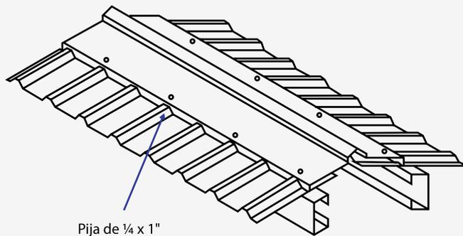
El **caballete para lámina CM-100 / CM-72** es un moldura para cubrir el parteaguas de un techo construido con láminas acanaladas del mismo tipo.
