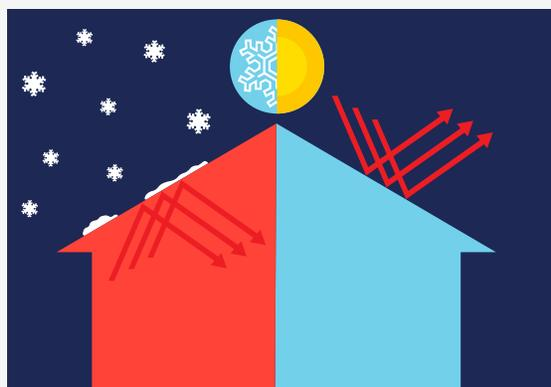
**R-FOIL** es un aislamiento reflectivo que se compone de una doble capa de burbujas de polietileno y dos superficies altamente reflectantes.
