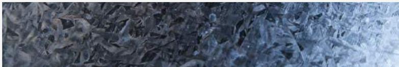
Placa de acero recubierta a base de zinc por medio del proceso de inmersión en caliente, designada bajo las siguientes calidades.
