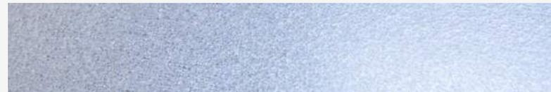
Es un producto revestido por el proceso de inmersión en caliente con una aleación de aluminio (Al) y zinc (Zn), con elevada resistencia a la corrosión para aplicaciones que requieren conformado en frío y estructurales, su aleación está compuesta por aluminio (50%), zinc (43.5%) y silicio (1.5%).
