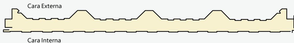
Es un panel para cubiertas que está compuesto por un núcleo de espuma rígida de poliuretano y dos caras de acero en grado 37, ambas caras van adheridas químicamente mediante el propio núcleo.
