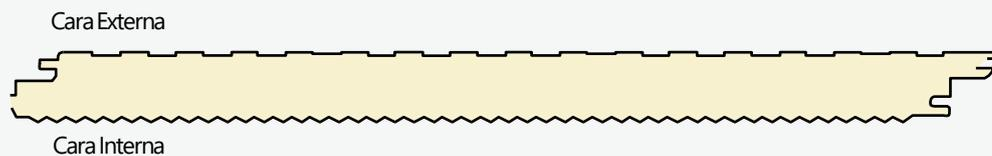
Es un panel aislante para muros, fabricado en un proceso continuo y diseñado para cumplir con las especificaciones más exigentes del mercado, por su unión lateral proporciona hermeticidad, ofrece un excelente aislamiento térmico y resistencia estructural a la Intemperie.
