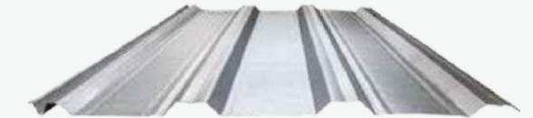
La lámina **RM-100/35** se fabrica a partir de rollos de acero de 1.22 m de ancho, su poder de cobertura es de 1m y su peralte de 3.5cm.
